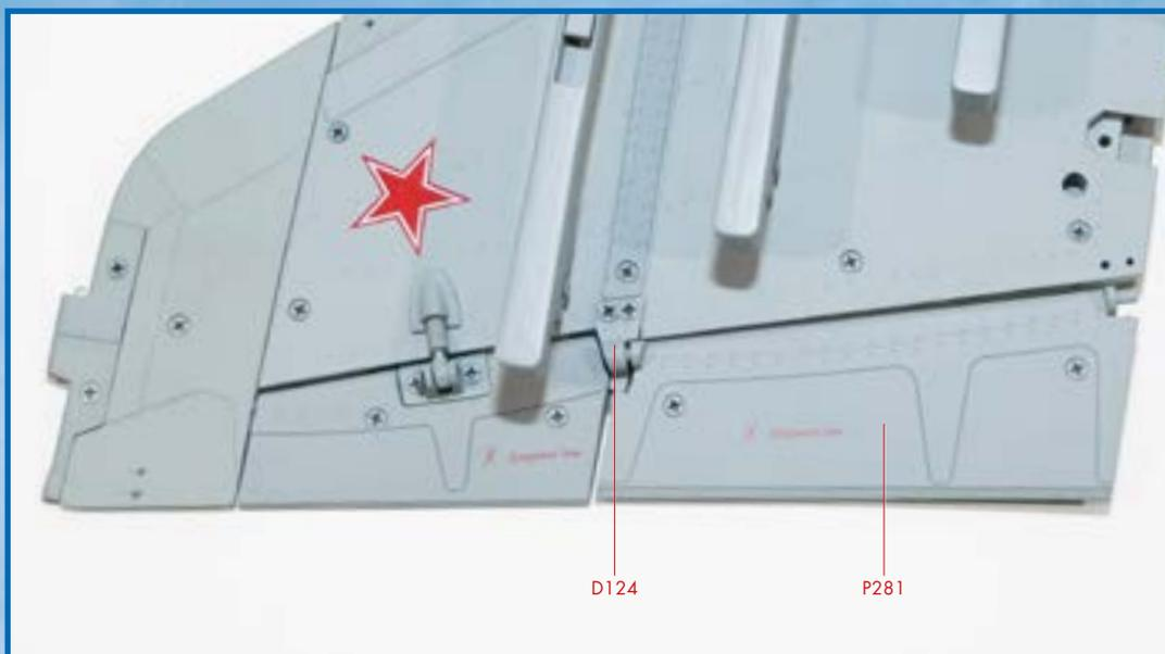
**4** Затем установите петлю (D125) на нижней поверхности консоли крыла, как показано на снимке, и зафиксируйте ее двумя винтами LP.
