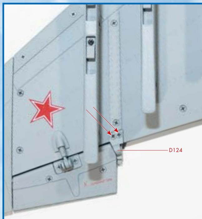
**1** На этом этапе сборки вам потребуются детали, полученные с этим номером, и узлы деталей из № 107 и № 98. Соедините детали P281 и P282, как показано на снимке, и закрепите их двумя винтами LP.
