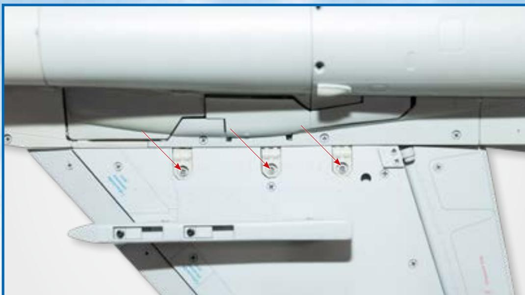
**8** Затем снизу зафиксируйте консоль крыла винтами RM в местах, указанных на снимке.
